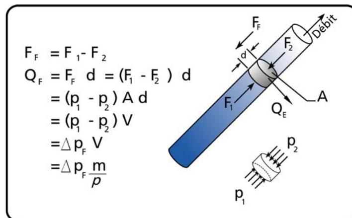
Figure 2-6 La perte de chaleur due au frottement du fluide dans une conduite.
