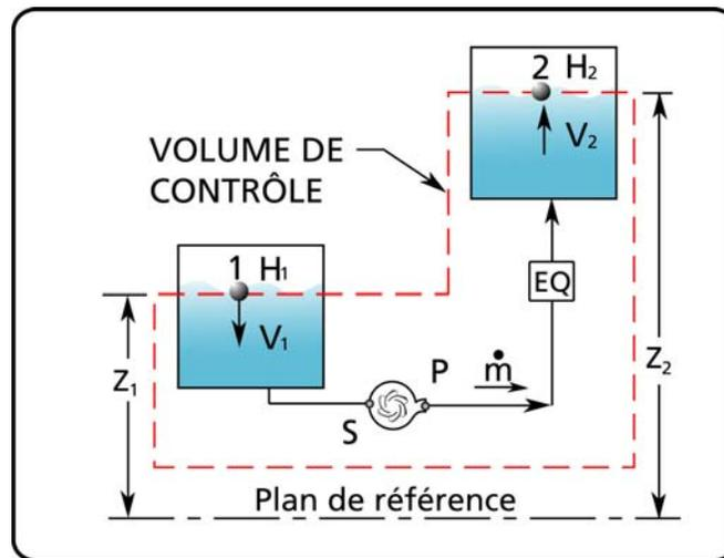
Figure 2-8 Le positionnement correcte du volume de contrôle dans un système de pompage.
