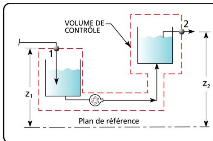
Figure 2-7 Position incorrecte du volume de contrôle.
