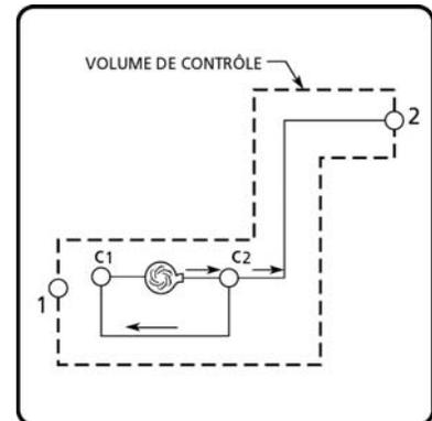
Figure 2-18 l'effet des connexions interne dans un système.
